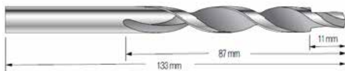
PUNTA DE BROCA PERFORADA A DOBLE DIAMETRO (Ø4 & Ø8 mm)
